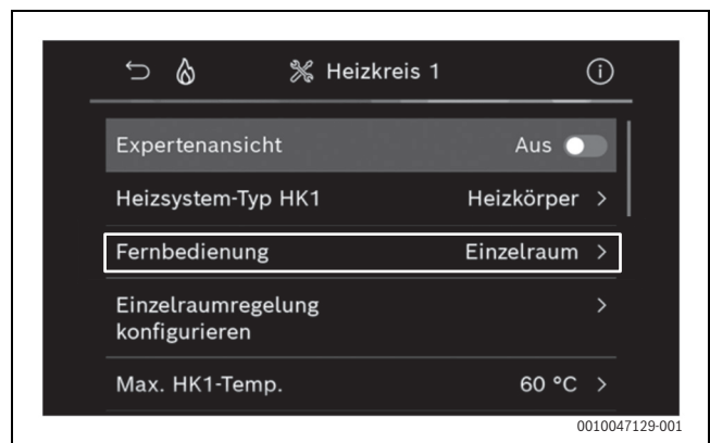
Bild 3 Beispiel Gas-Brennwertgerät; Einzelraumregelung Heizkörper
