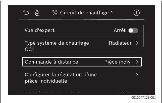
Fig. 3 Exemple d'une chaudière gaz à condensation ; régulation d'une pièce individuelle via des radiateurs
